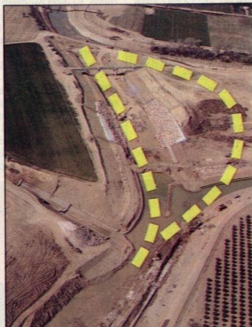
Il corso del fiume Basento durante i lavori di "raddrizzamento". Le linee tratteggiate indicano: quella di destra il meandro naturale; quella di sinistra la scolmatura che annulla il letto naturale del fiume
